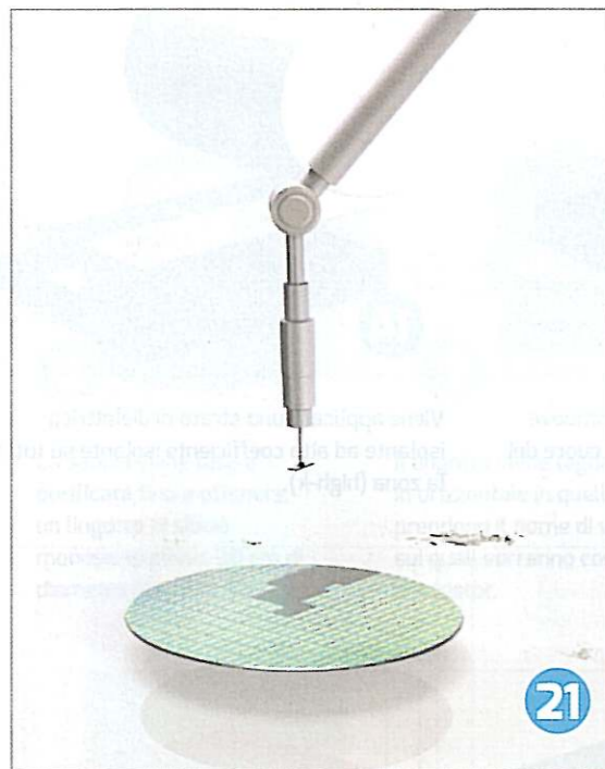
Separati uno a uno vengono tagliati con precisione e prelevati da macchinari appositi.
