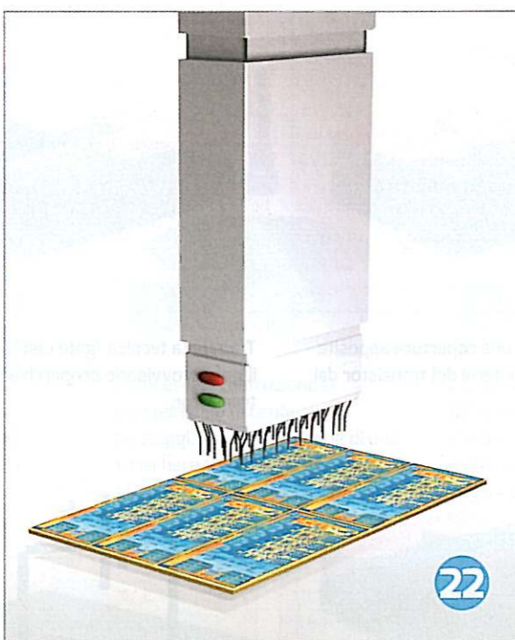
I processori sono pronti e vengono testati sommariamente per valutarne il funzionamento.
