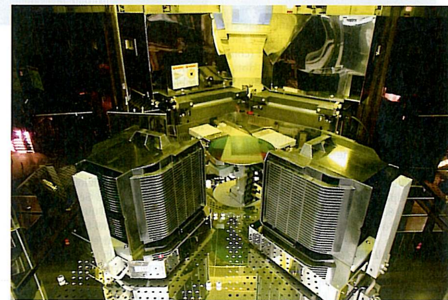
Appositi contenitori accolgono i wafer prima e dopo il trattamento. Sono mantenuti separati e in ambiente asettico e controllato; ogni granello di polvere depositato in questa fase significherebbe un chip non funzionante.
