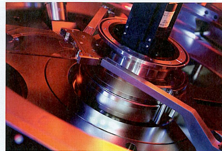
Una macchina deposita il materiale fotoresistente sul wafer. Si utilizza un piatto rotante in modo da "spalmare" tale strato in maniera uniforme.
